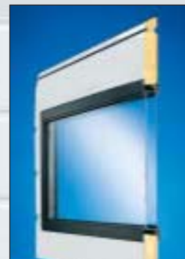
Lamelle mit Sandwichverglasung, Typ A, 26 mm dick, Doppelrahmen mit EPDM-Dichtung.
