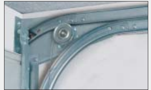
Niedrigsturz-Beschlag mit hintenliegender Federwelle, ab 250 mm Sturzbedarf.
